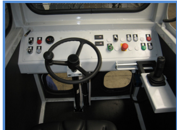
• Der GT ist mittels Joystick und Lenkrad leicht zu fahren
