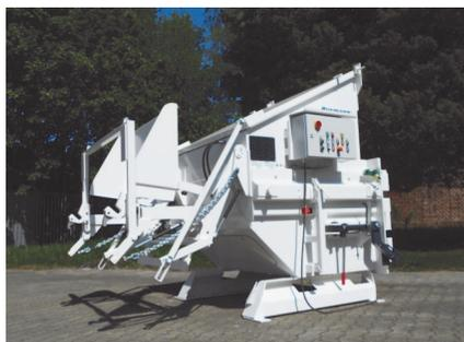
• ST - AN mit angebauter Hub-Kippvorrichtung
